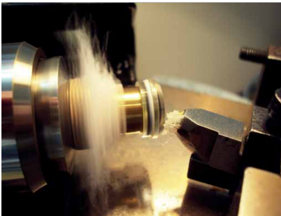
soustružení přední plochy kontaktní čočky
